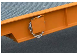
Chaînes et crochets d'attelage côté remorque
